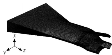
图 9 中介机匣计算模型
